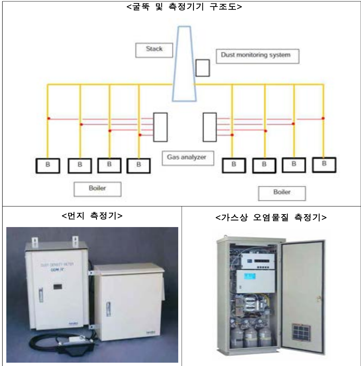
[그림 91] 몽골 TES-4 대기오염 배출량 모니터링 시스템
